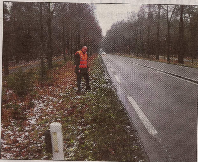
Henk Pannekoek laat zien wat de resultaten zijn op de proefstrook met zwijnverdwijnblokken op de provinciale weg N309 bij Tongeren. De hele berm is omgewoeld, maar waar de zwijnverdwijnblokken liggen is het glad gebleven.
