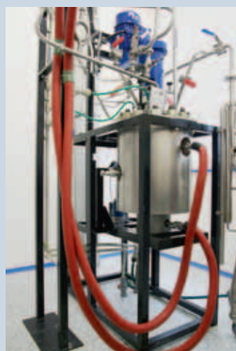
20 L autoclaaf voor drukreacties
